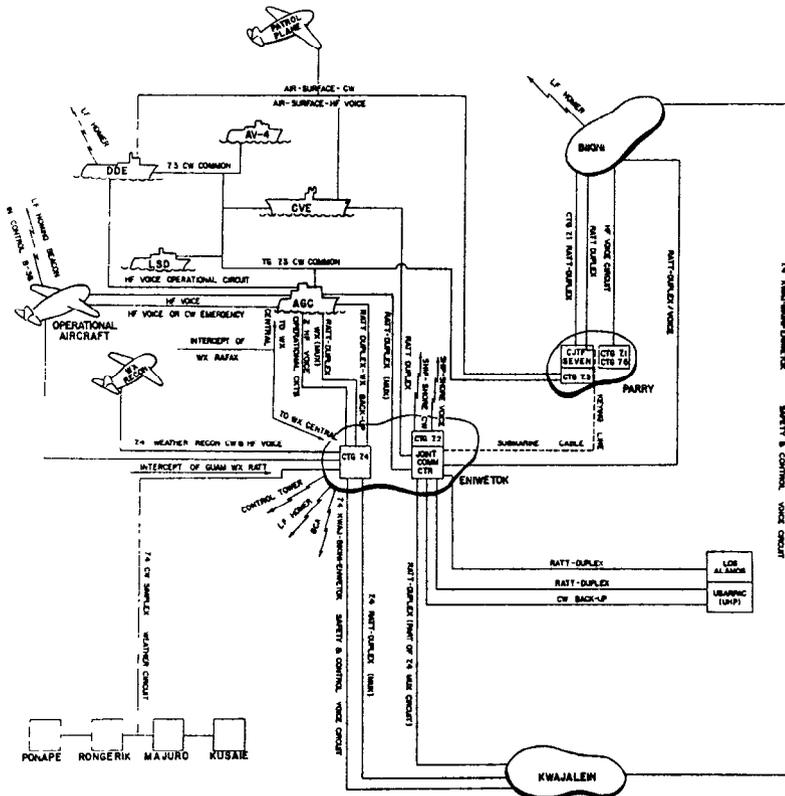
PRINCIPLE TASK FORCE HF RADIO CIRCUITS
